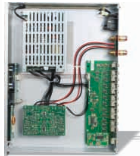
Piekfein: Das Innenleben der Arcus-Geräte überzeugt mit durchdachtem und servicefreundlichem Layout. Verblüffend ist der geringe Platzbedarf für die digitale Endstufe im DPA 300 (kleine Platine im rechten Bild).
