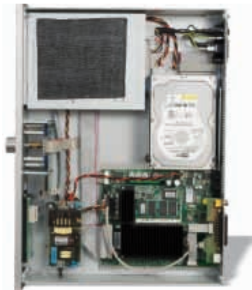
Piekfein: Das Innenleben der Arcus-Geräte überzeugt mit durchdachtem und servicefreundlichem Layout. Verblüffend ist der geringe Platzbedarf für die digitale Endstufe im DPA 300 (kleine Platine im rechten Bild).
